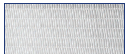
Medium-Filter (Class F8) มีประสิทธิภาพในการกรองฝุ่นละอองขนาดตั้งแต่ 0.3-1.0 ไมครอน ถึง 98% โดยเฉลี่ย
